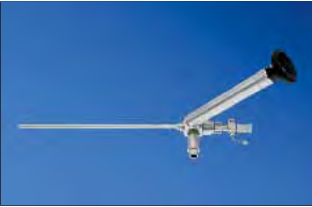
HOPKINS ® Weitwinkel-Geradeausblick-Optik 6° mit abgeschrägtem Okularteil, Länge 15 cm, autoklavierbar, mit integrierten Fiberglas-Lichtleitfasern (Stäbe) und Arbeitskanal Ø 3 mm (KARL STORZ 28096 AGA).
